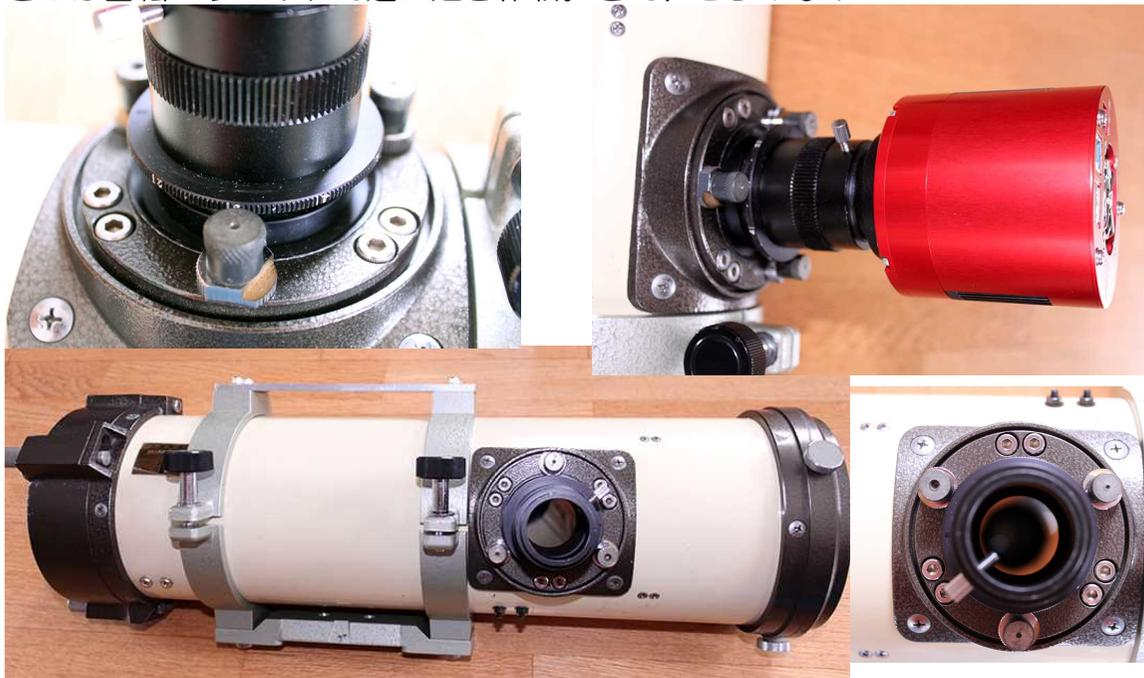
次の復活計画はATIK383L+という冷却CCDカメラだ。これまたずいぶんご無沙汰なのだが、フィルターホイールが2インチ対応のものなので、54mmネジでの接続になっていて、結構苦労して取り付けしている。しかし、これが曲者で面倒くさくなってDRYBOXの肥やしになっている。
