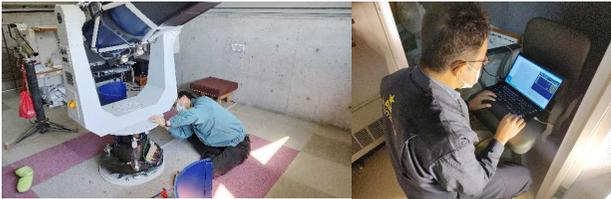
まず、新しいOSと制御ソフト等を組み込んだSSDを製作。コントローラPCのCPUボードを高速・高性能なものに更新。それから、細部の設定を行って、17時過ぎ頃に制御システムの更新
