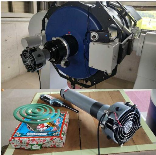
試作品の部品構成を、少し変更して完成させました。ファン(80mm、速度調節付き)+異径継手(75mm-40mm)+送風パイプの構成。パイプの先端は塞いで、横4方向に開口を開けています(この部分は試作品のままです)
